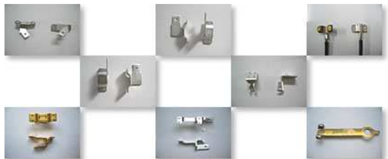
順送金型による自動プレス(端子プレス品)
